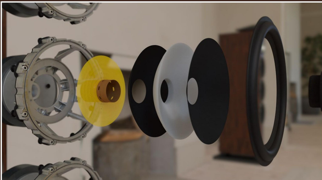
Die Explosionsgrafik des Tieftöners zeigt den aufwendigen Aufbau des Chassis. Die hier zu findene ultraleichte und ultrasteife Aerofoil-Membran wird auch in der 800er Serie von Bowers & Wilkins verwendet
