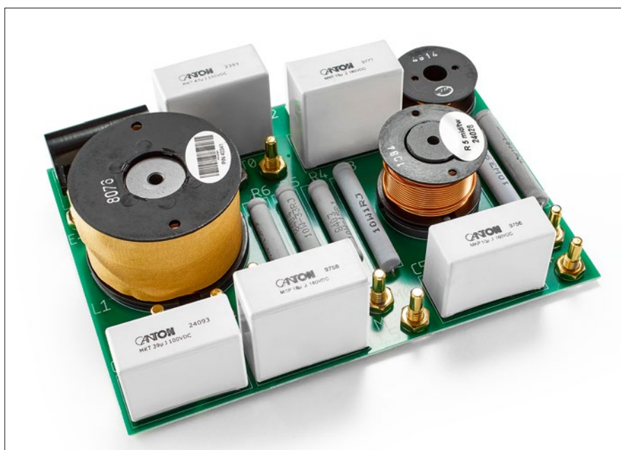
Der Hochtonzweig der Frequenzweiche ist als Linkwitz-Riley-Filter 4. Ordnung ausgeführt, während der Tiefton- und Mitteltonbereich mit Filtern 2. Ordnung arbeiten
