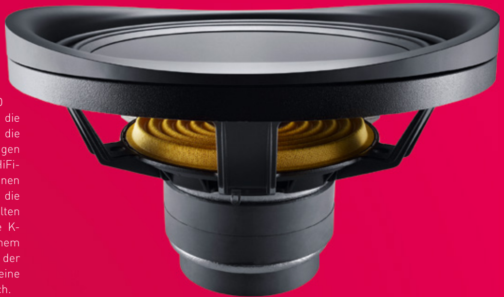
Ein Korb aus resonanzarmem Polycarbonat hält die überarbeitete Zentrierspinne sowie die Membran aus einer Wolfram-Keramik-Komposition
