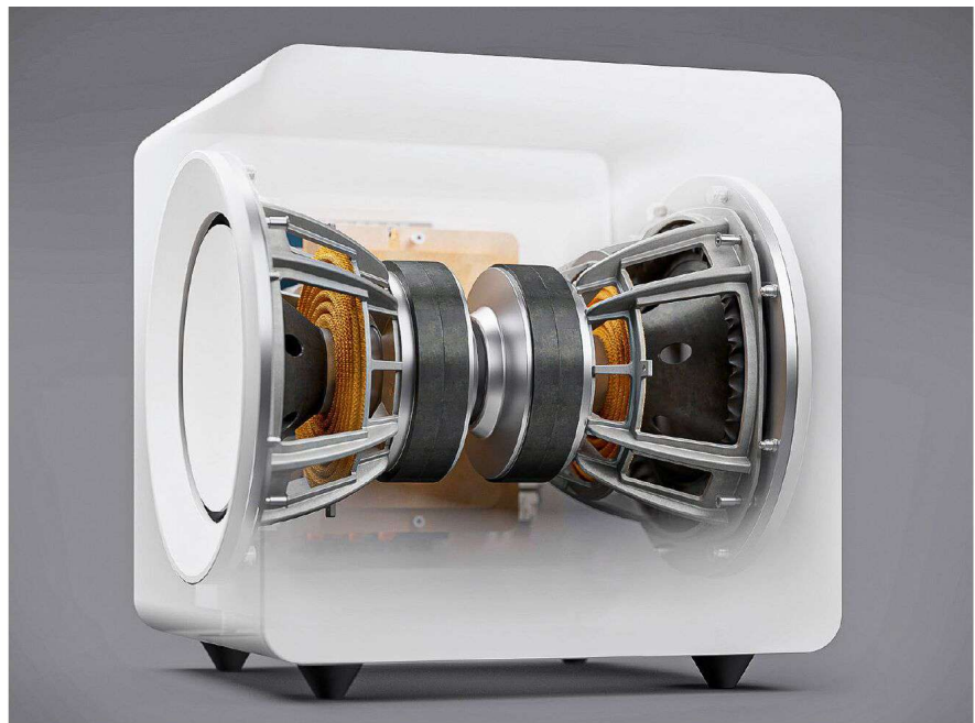
Im KC92 sitzen zwei hubstarke 23er-Woofer Rücken an Rücken. Bei gleichphasigem Antrieb addieren sich so die Schalleistungen, aber die Krafteinwirkung auf das Gehäuse wird gegenseitig absorbiert.
