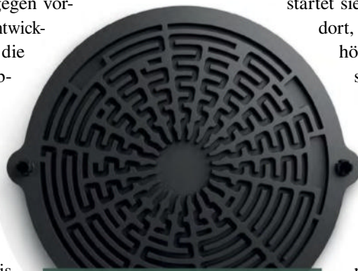
Die labyrinthartige Struktur auf der MAT-Scheibe am Ende des Uni-Q-Treibers soll unerwünschten rückwärtigen Schall vom Hochtoner absorbieren.
