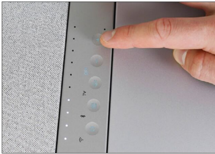
Die Knöpfe sind berührungssensitiv, daneben liegt eine Lautstärkeanzeige.
