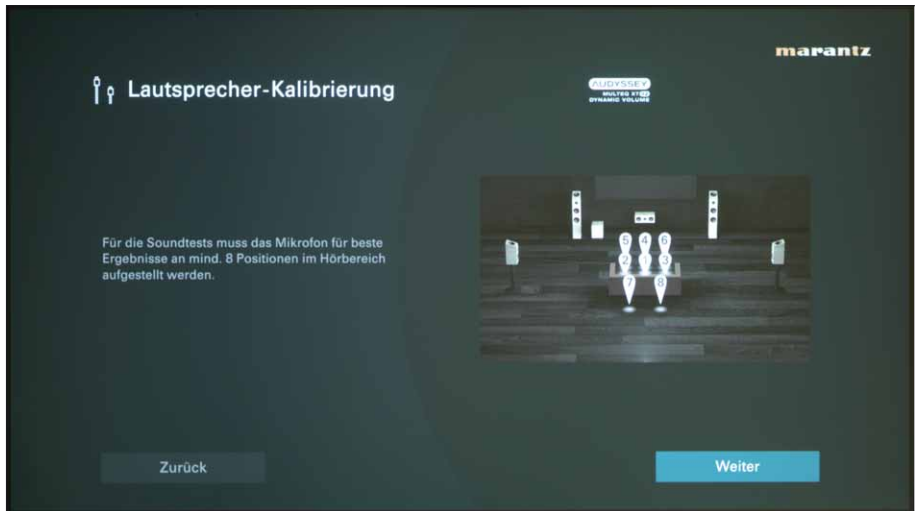
Zum Abschluss werden die angeschlossenen Lautsprecher mithilfe des beigelegten Mikrofons auf die Raumakustik eingemessen
