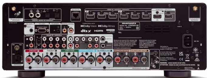
Sieben Endstufen und ebenso viele Lautsprecherterminals beschränken die Einsatzmöglichkeiten des Cinema 60, dafür gibt es eine Buchse für eine UKW-Antenne, das DAB-Modell kostet nur 50 Euro mehr
