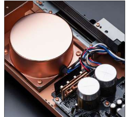
In besonders kritischen Zonen finden sich streufeldarme „lineare“ Ringkerntransformatoren.
