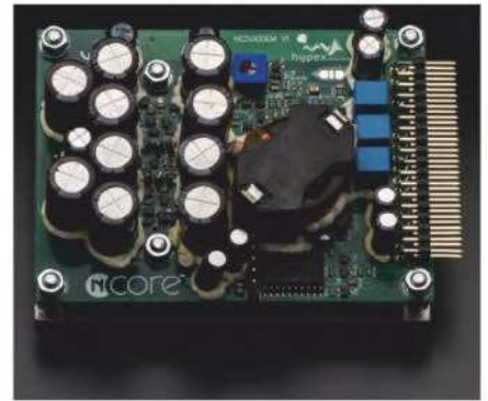
EDEL BIS INS DETAIL: Sämtliche Baugruppen zeugen von Sorgfalt und Aufwand. Der kleine Ringkerntrafo (links in der Mitte) ist für die Vorstufe reserviert.
