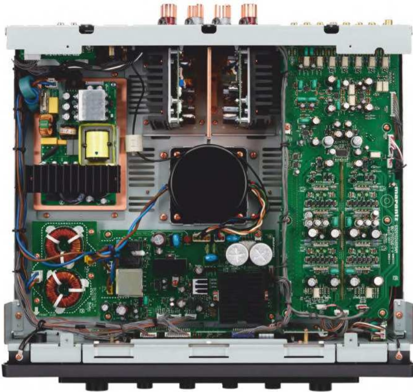
EDEL BIS INS DETAIL: Sämtliche Baugruppen zeugen von Sorgfalt und Aufwand. Der kleine Ringkerntrafo (links in der Mitte) ist für die Vorstufe reserviert.
