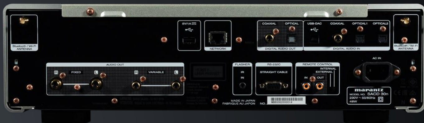
Der 30n ist das digitale Gehirn der 30er-Serie. Den hochwertigen analogen Audioausgang gibt es gleich zweimal – einmal mit variabler Lautstärkeausgabe und einmal mit konstantem Level, etwa für den Betrieb am Model 30
