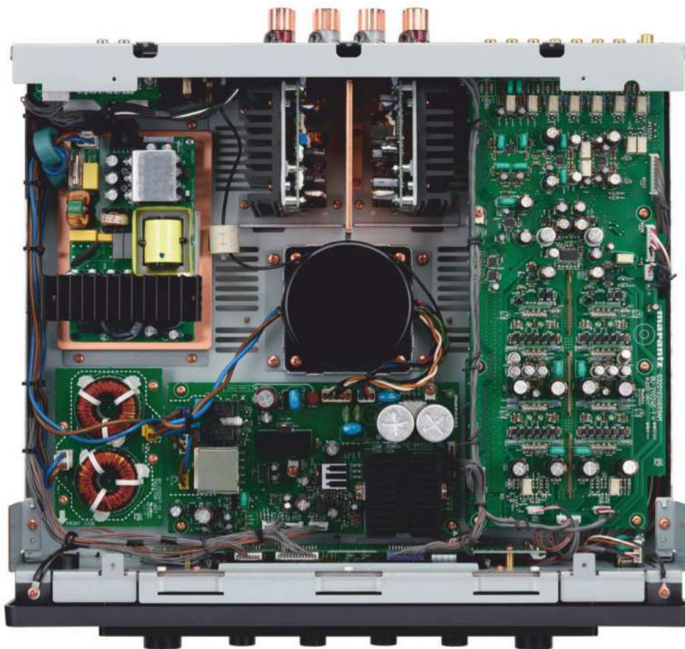
Etwas unerwartet haben wir es beim Marantz Model 30 mit einem Class-D-Verstärker zu tun. Die Vorstufe rechts bietet einen recht klassischen Transistorparcour. In der Mitte sitzt der Trafo. Links wird die Kraft aufbereitet, direkt an den Klemmen in der Mitte sitzen die zwei Class-D-Endstufen.
