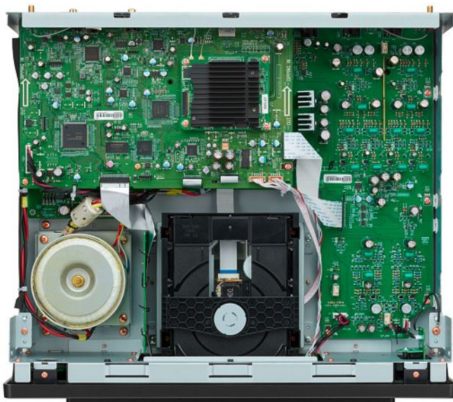
Im Marantz-Player sind vorne Laufwerk, Netzteil und oben die Digitalplatte gut auszumachen. Rechts befindet sich die analoge Ausgangsstufe.
