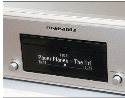
Der CD50n informiert über Quelle, Interpret, Titel und gegebenenfalls auch die Datenrate.
