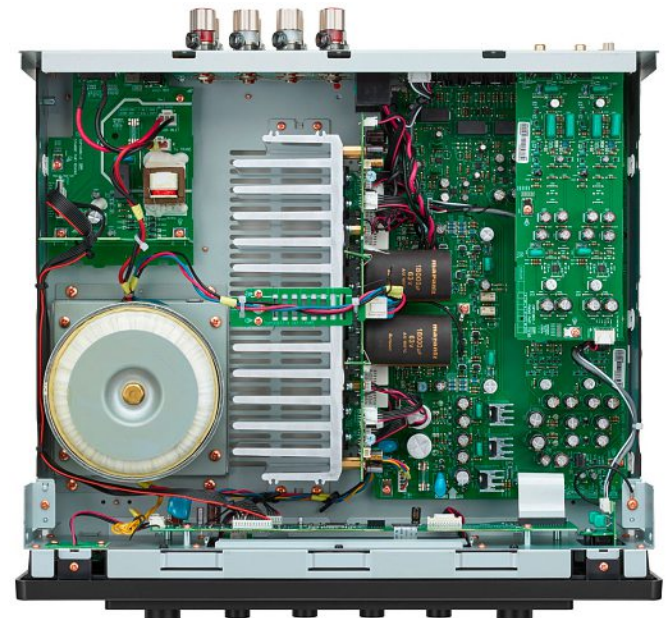
Die Innenansicht des Marantz-Vollverstärkers ist von einem üppigen Ringkerntransformator (links) und großem Kühlkörper gekennzeichnet.
