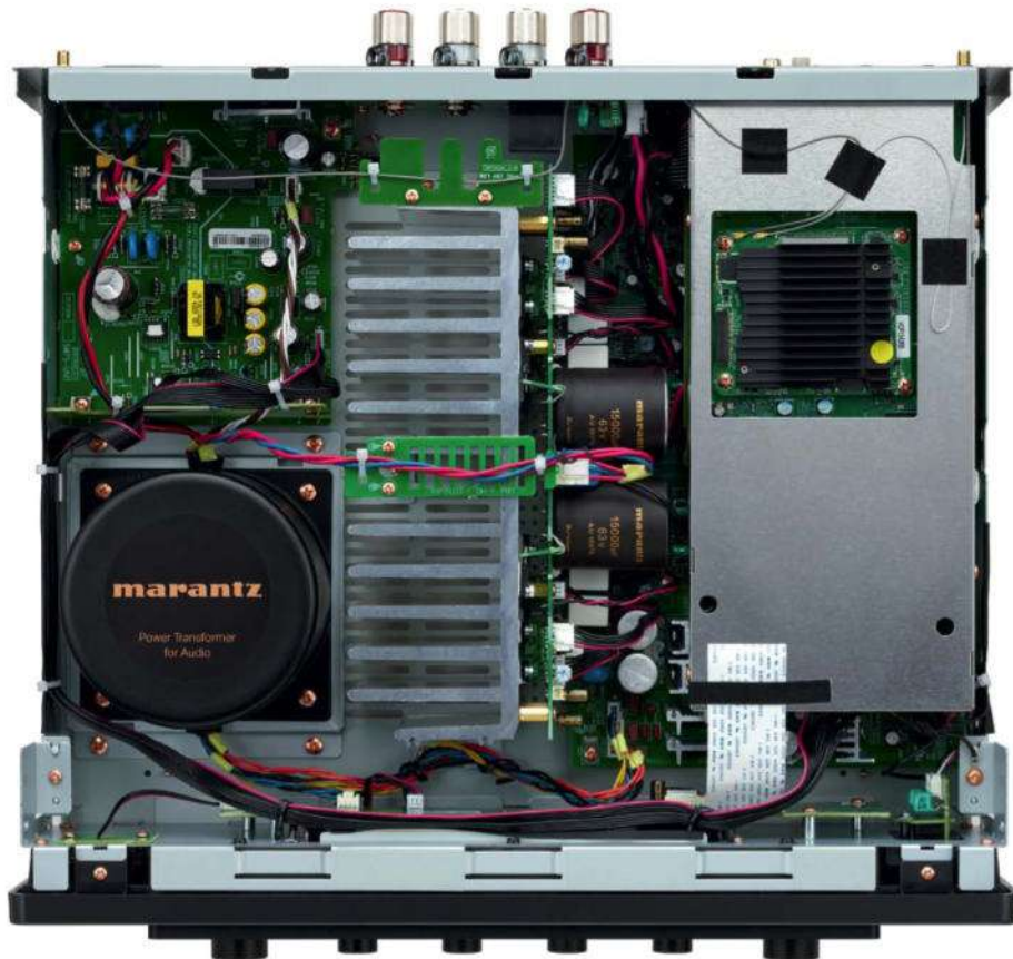
KOMPAKTE ENDSTUFE: Der nominal mit 60 Watt spezifizierte Vollverstärker wirkt subjektiv kräftiger, als es die reinen Daten vermuten lassen. Vorstufen und Digitalteil (rechts) unter Abschirmung.
