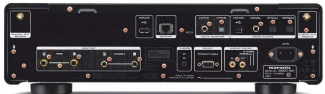
Ein Blick auf die Anschlüsse des SACD 30n weist auf die Vorstufenfunktion hin: Die Eingänge umfassen SPDIF koaxial und 2x optisch sowie USB. Die Ausgänge sind in Cinch, nicht aber in XLR ausgeführt.
