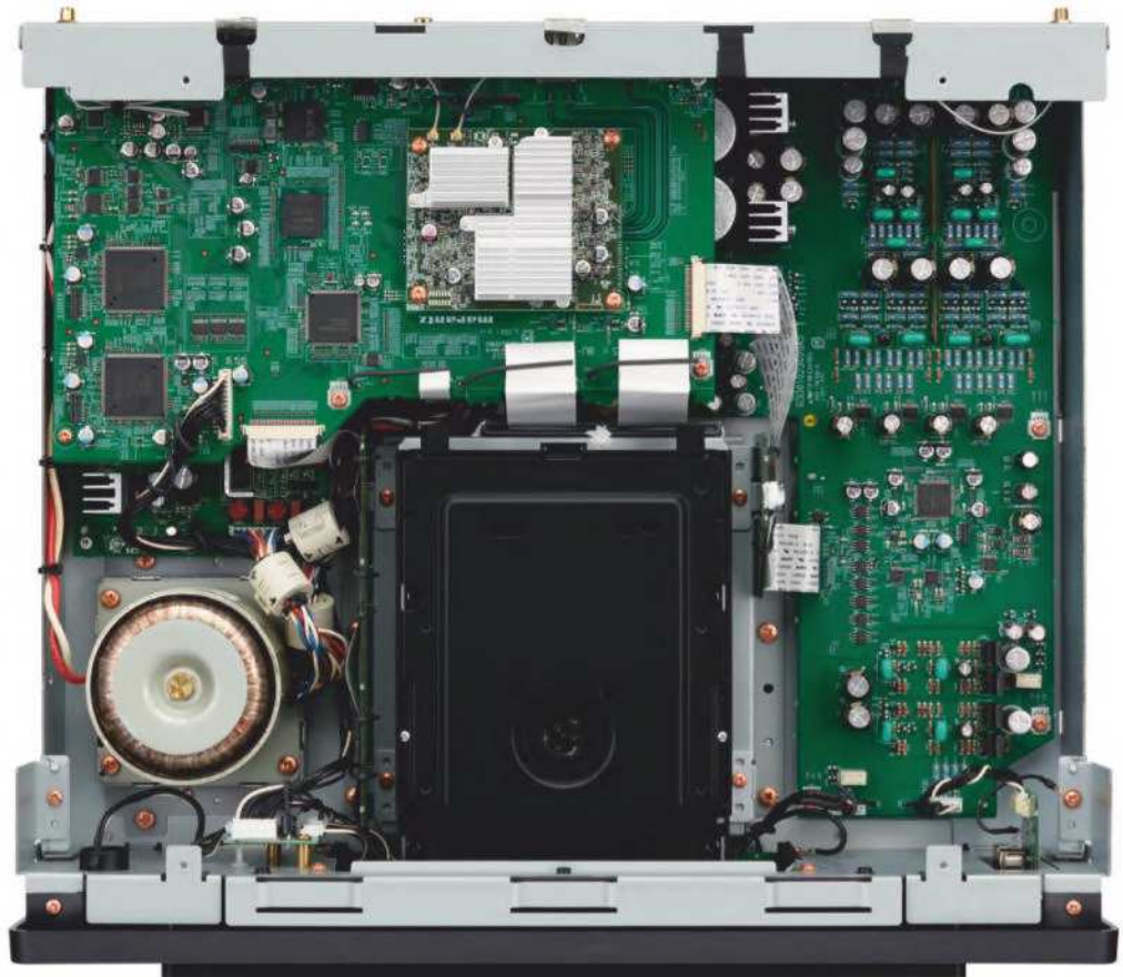
Das Innenleben zeigt Profi-Platinen – links für Digital- und Netzwerk, rechts für den Analogbereich. Die Huckepack-Platine ist für HEOS und Streaming zuständig, die Stromversorgung erfolgt per Ringkerntrafo.
